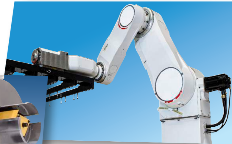
3軸ロボット液晶パネル搬送
